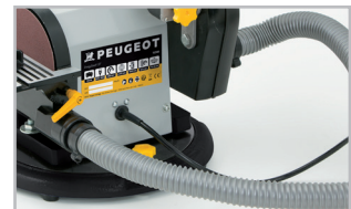
2 buses d'évacuation des poussières 2 Dust collector nozzles
